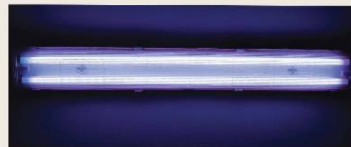
Hình 15.2 Đèn huỳnh quang khi có dòng điện xoay chiều chạy qua
