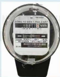
a) Công tơ điện cơ
