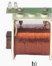
Hình 1.6 Sơ đồ mô tả cách mắc đèn LED với cuộn dây dẫn (a), cuộn dây dẫn kín có hai đèn LED (b)
