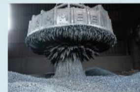
Hình 15.5 Ứng dụng của dòng điện xoay chiều tạo nam châm điện
