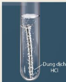
Hình 19.1 Phản ứng của đinh sắt với dung dịch HCl
